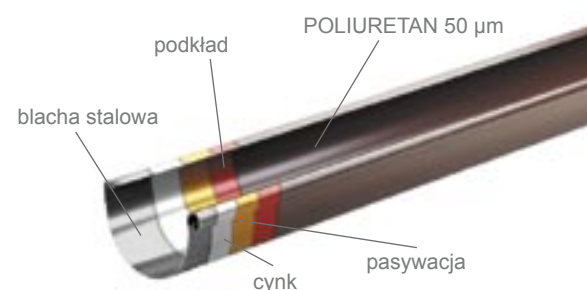
Układ warstw zabezpieczających
