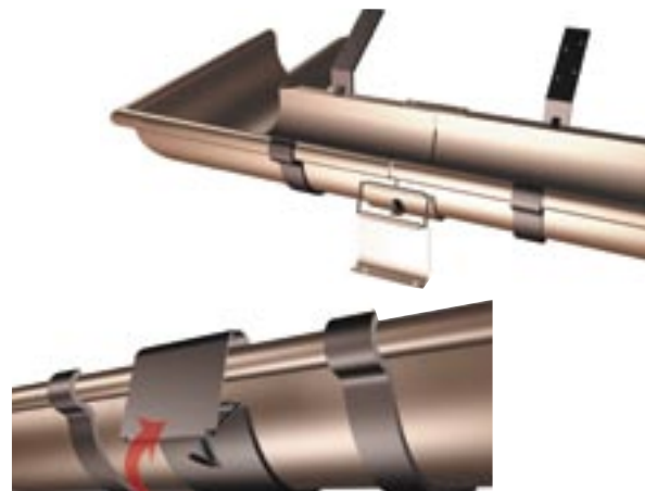
Złączkę zakładamy na łączone rynny i zatrzaskujemy. Pomiędzy rynnami należy zachować odstęp ok. 5 mm.
